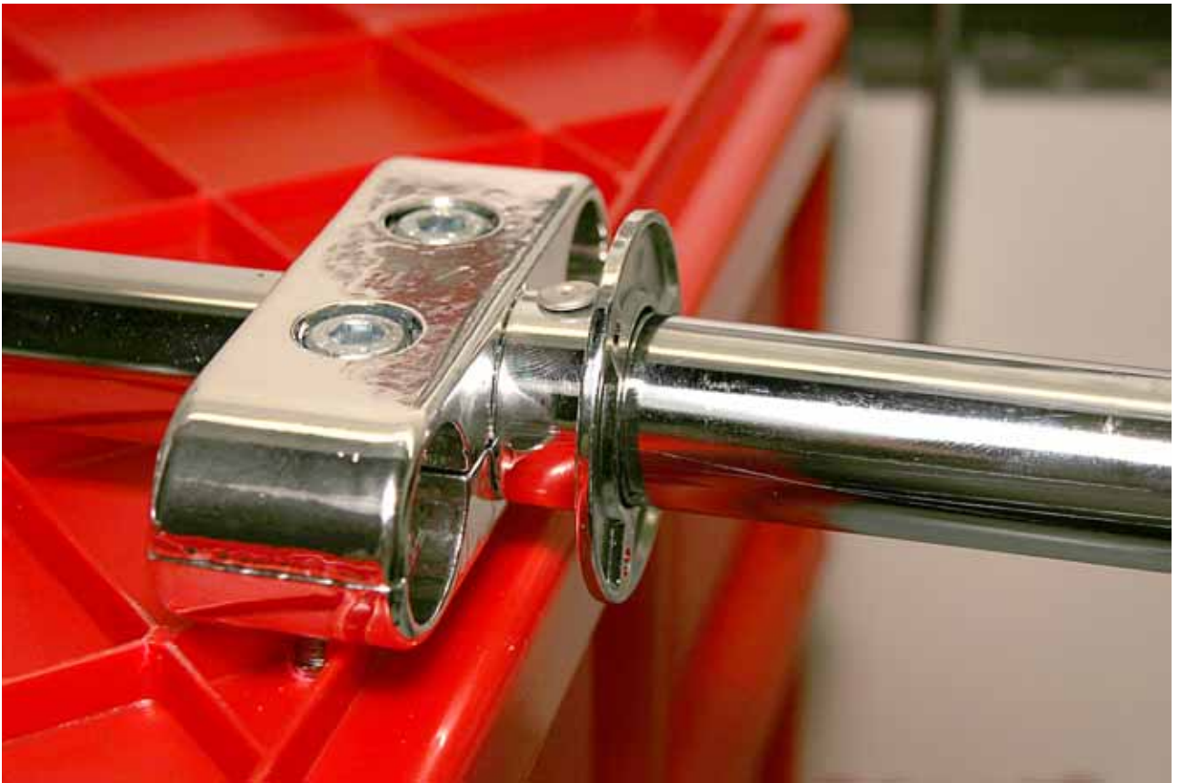
L'assale con il supporto fissato alla cassetta e il supporto circolare fissato con un rivetto a strappo (oppure autofilettante)
