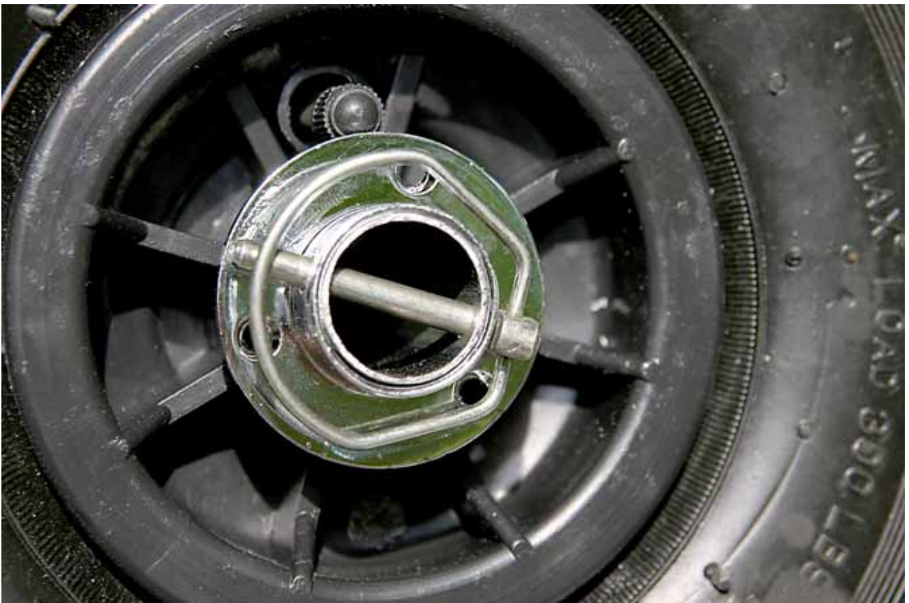
dopo avere inserito la ruota inserire l'altro supporto circolare, forare il tutto lasciando un minimo gioco assiale per la ruota e inserire la spina con anella elastica di ritegno.
