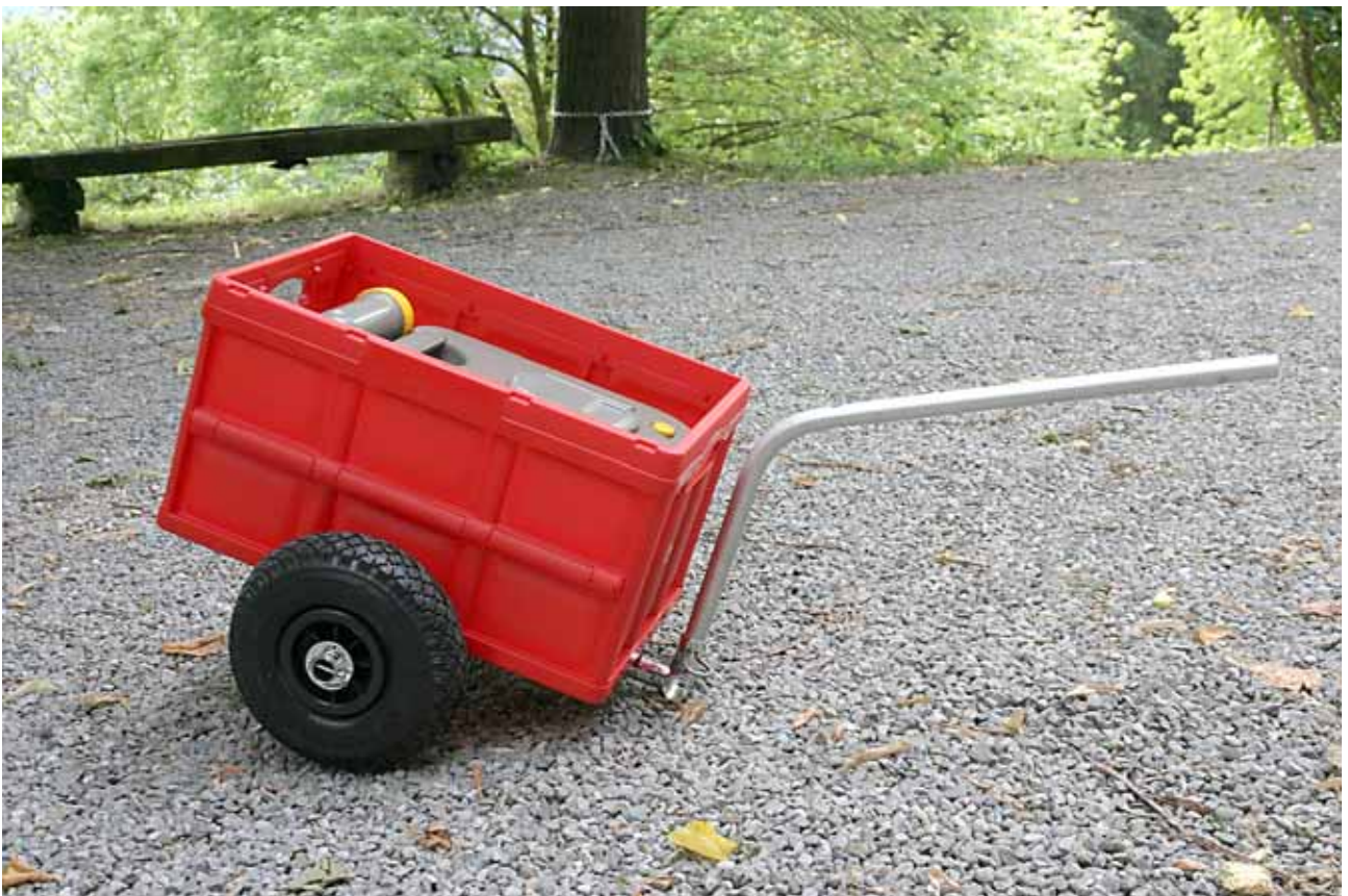
il carrellino finito, con al suo interno la cassetta Tethford e con timone provvisorio .
