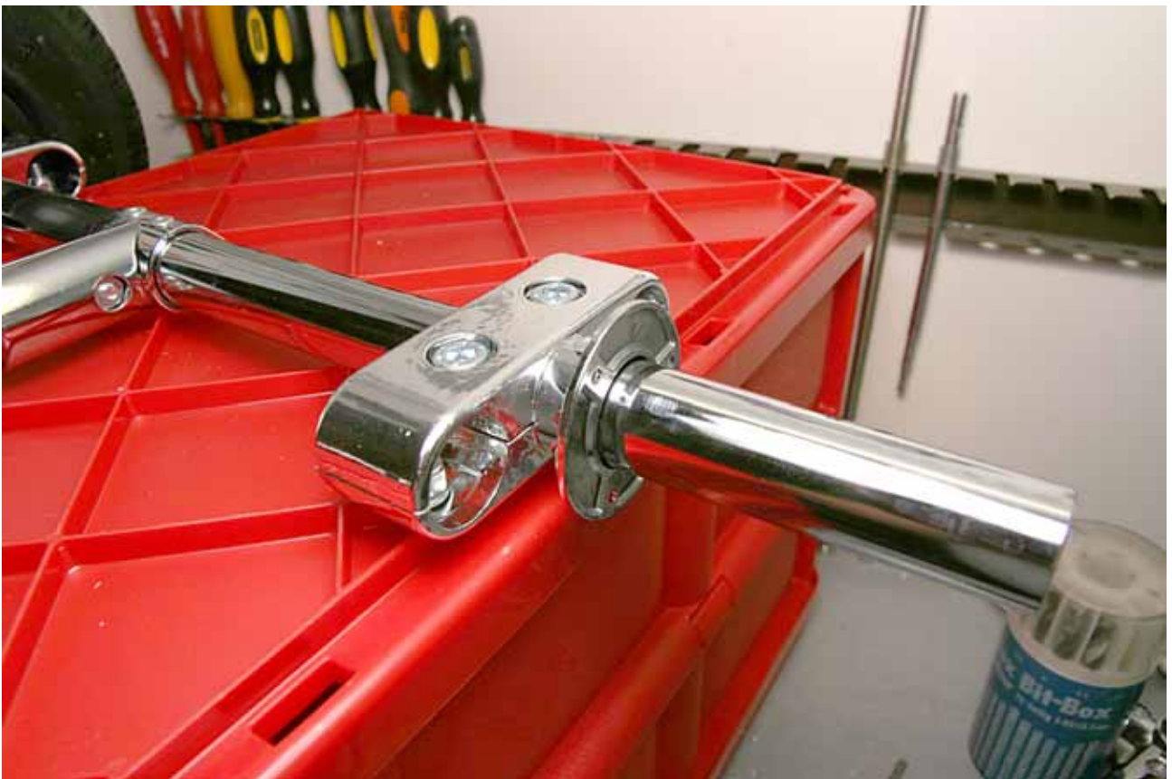
l'assale con il raccordo a T centrale fissato con due rivetti
