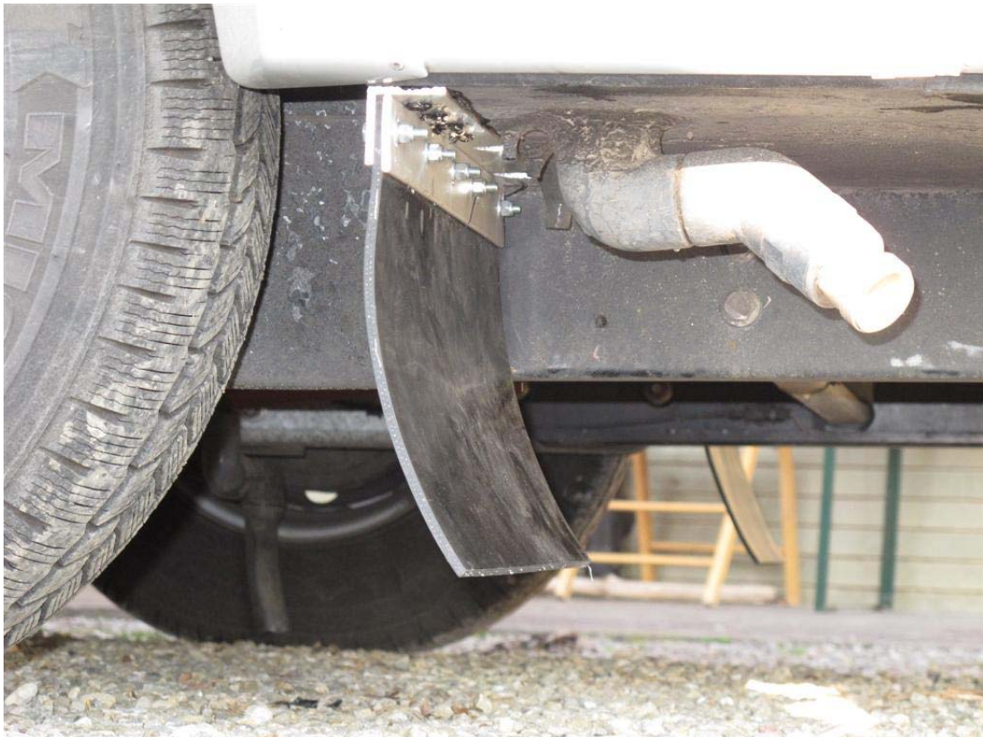
il paraspruzzi sinistro ripara dall'imbrattamento lo scarico delle grigie
