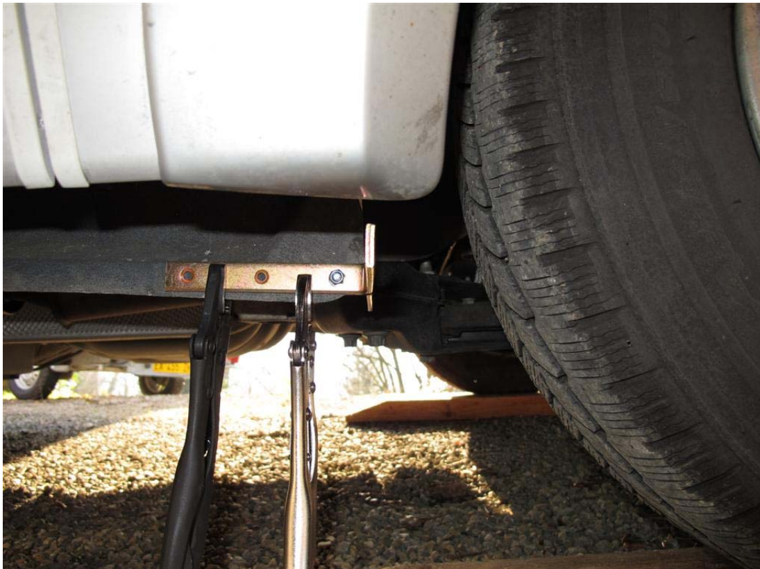
le squadrette fissate ai lati della lamiera e fissate con due bulloncini M6
