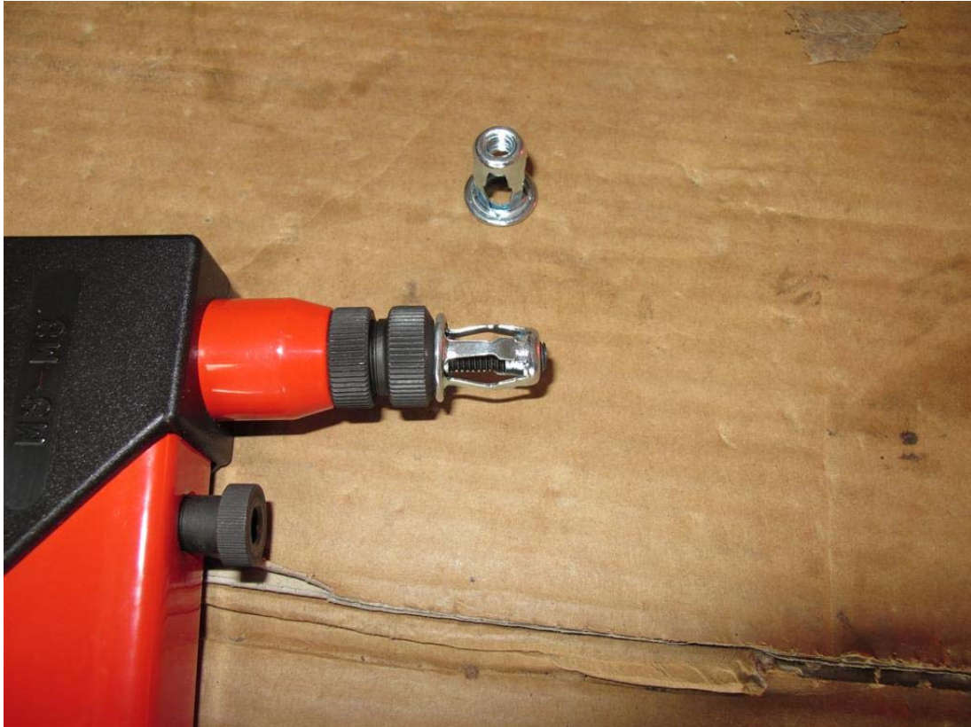
gli inserti filettati usati per il paraspruzzi sinistro
