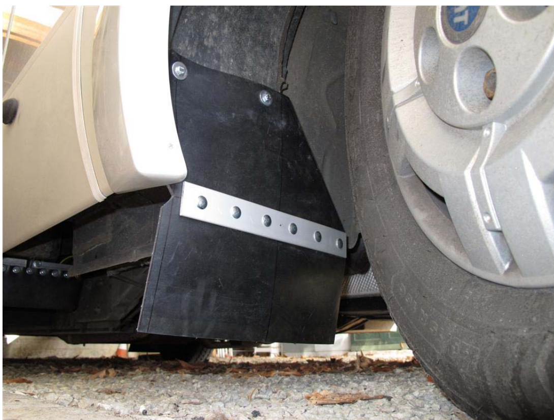
il paraspruzzi destro montato
