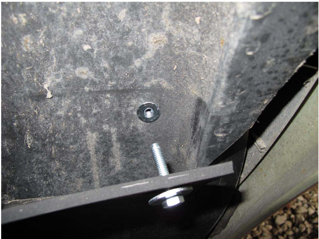
inserto filettato e il bullone per fissare la gomma
