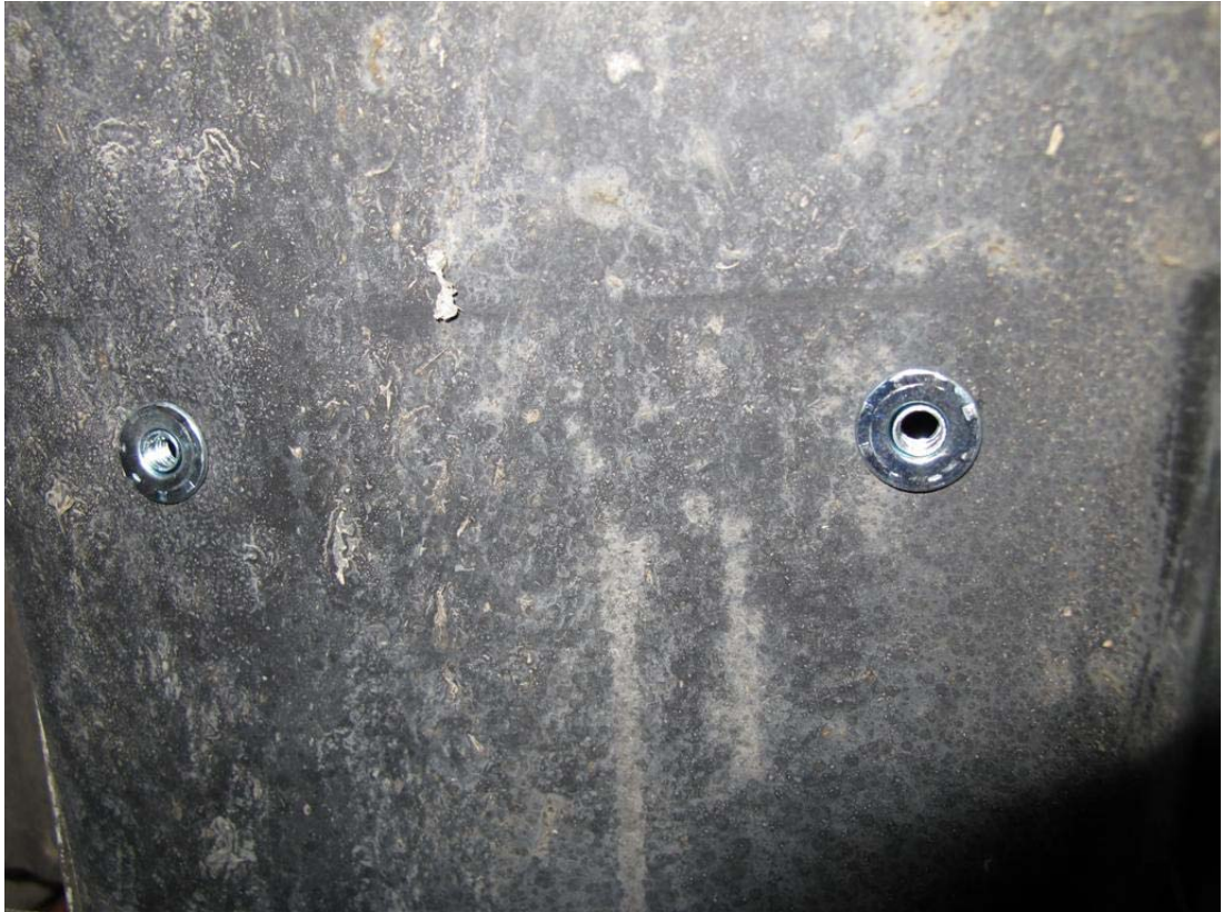
gli inserti filettati applicati sul passaruota di plastica
