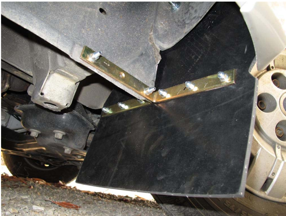
il paraspruzzi destro montato
