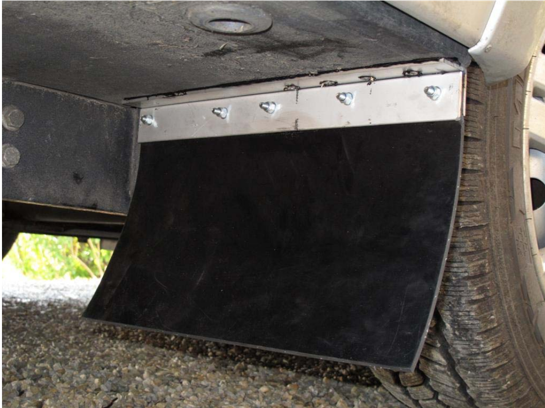
il paraspruzzi posteriore finito
