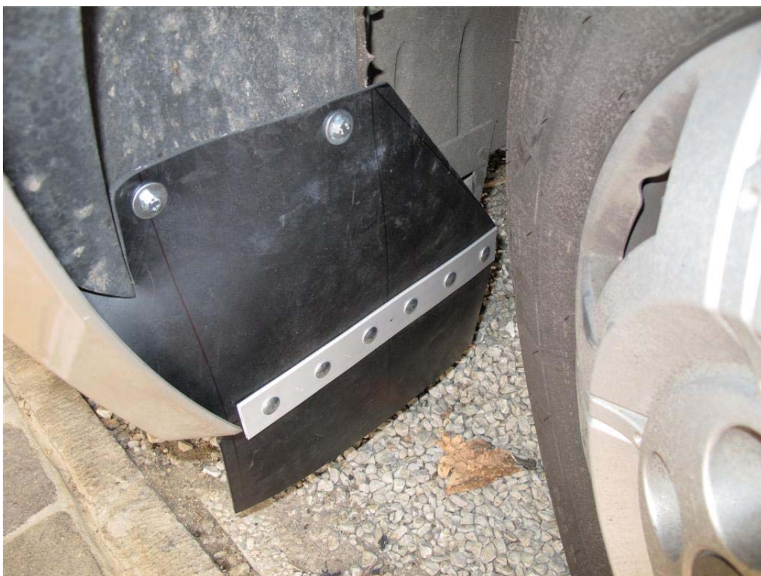
il paraspruzzi destro montato, notare la sagomatura per il passaruota
